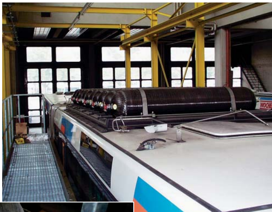
Bild 6 Flaschenbatterie mit Gastanks aus Kohlefaserverbundwerkstoff
