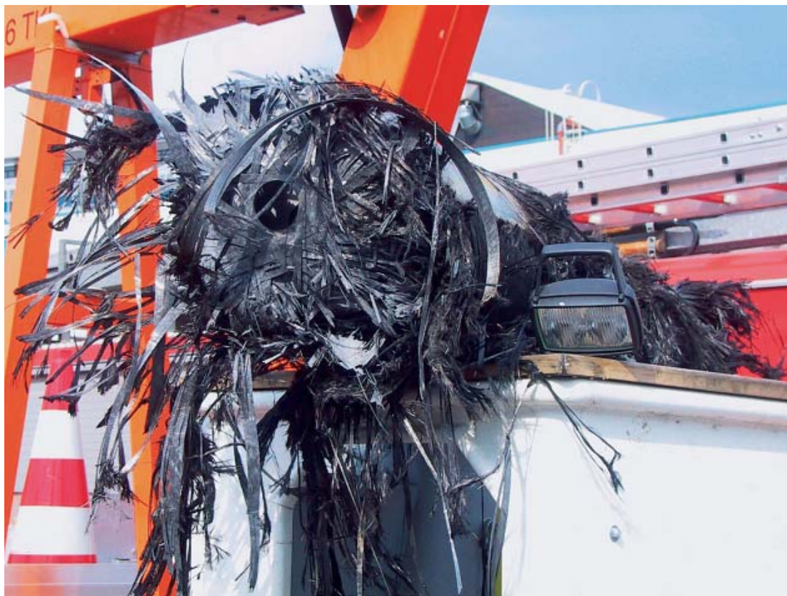
Bild 15 Trümmer des zerborstene Gastanks
