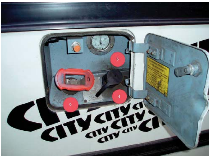
Bild 9 Befüllereinrichtung und Abdeckklappe eines CNG-Solobusses: 4 = Füllanschluss, 5 = Füllstandsanzeige, 6 = Tankventil
