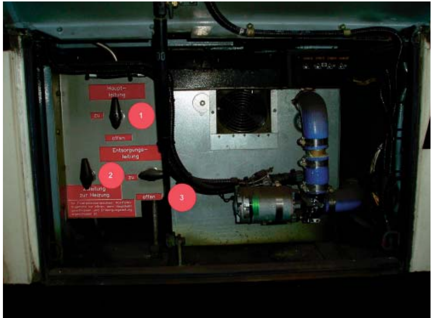
Bild 8 Ventilplatte mit Hauptabsperrrventil eines CNG-Solobusses: 1 = Hauptabsperrrventil für Gaszufuhr Motor, 2 = Absperrrventil Gaszufuhr Heizung, 3 = gesichertes Ventil der Entsorgungsleitung
