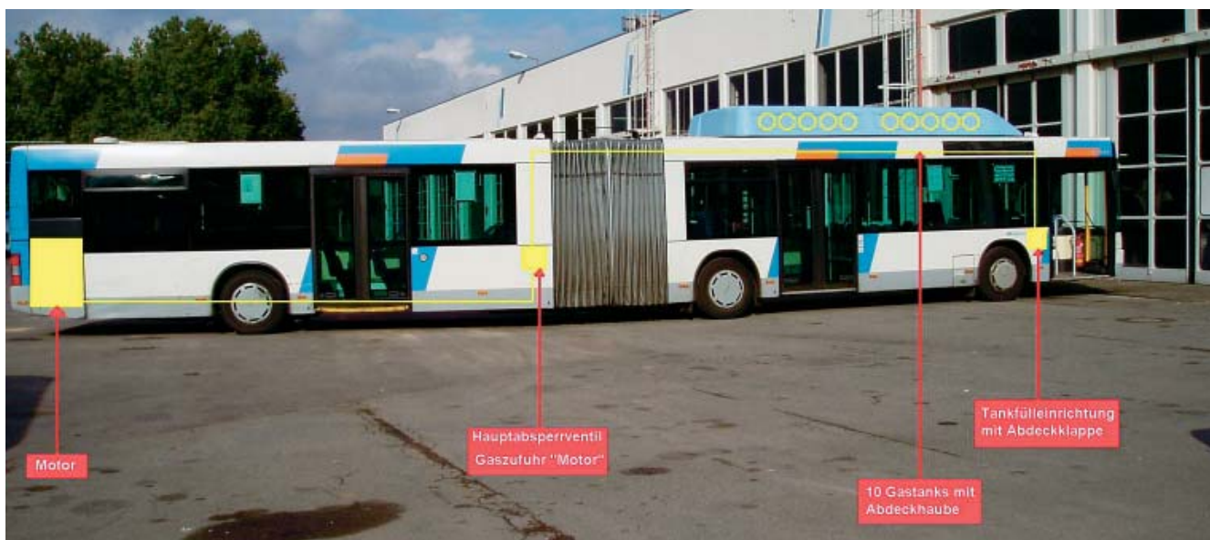
Bild 5 Gasstraße eines CNG-Gelenkbusses
